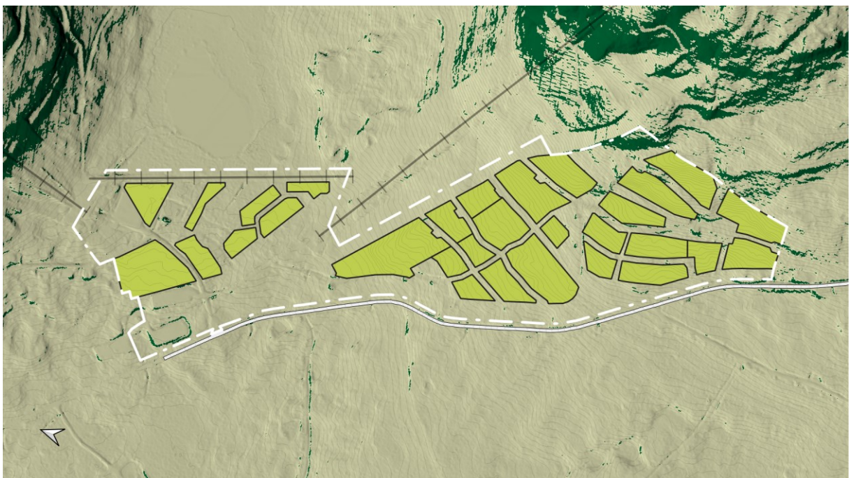
Karta 19. Områden med byggrätt, där lutningen är mindre än 1:3, vilket innebär att skred i morän inte är möjligt.
