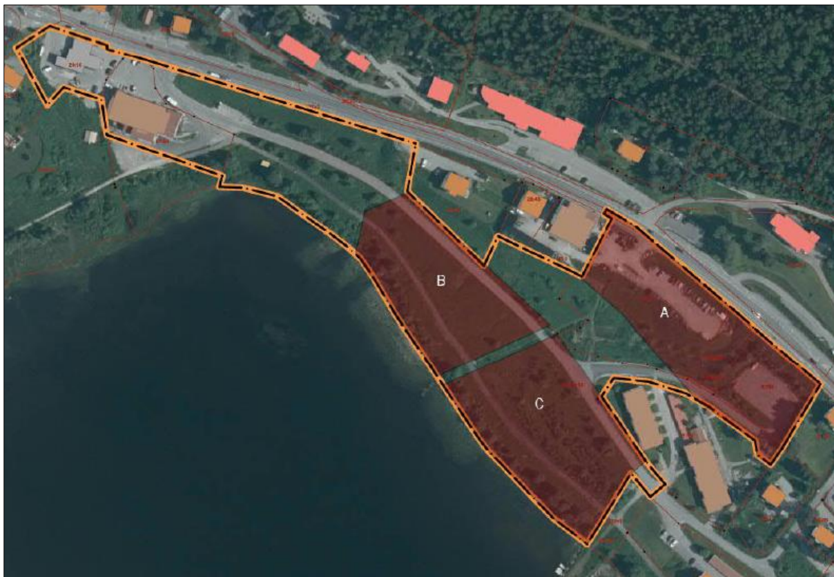
Figur 7. Översikt av indelning av delområden med hänsyn till utförda geotekniska undersökningar (Tyréns, 2022). Observera att planområdesgränsen är förändrad sedan den geotekniska undersökningen utfördes.
