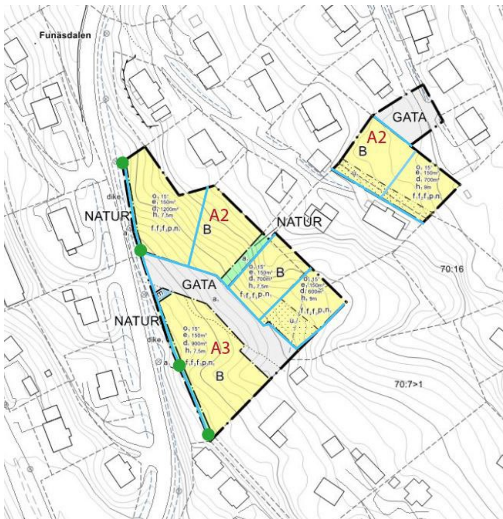
Illustration över föreslagna dagvattenåtgärder. Identifierade delområden, planerad markanvändning och strukturer såsom parkeringar och vägar, förslag till lämpliga rinnvägar i blått för efterläget och förslag till släpppunkter av hanterat dagvatten i gröna punkter, med avvattnande diken.
