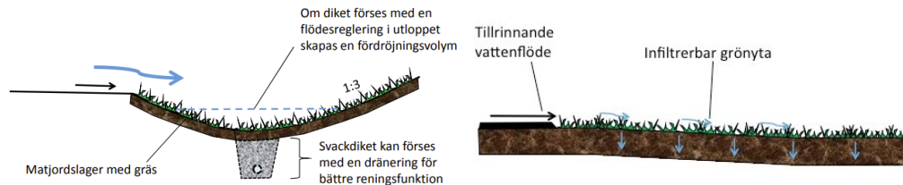
Figur 8 och 10 Exempel på svackdike och infiltrerbar grönyta, enligt Stockholm vatten och avfall, 2020
